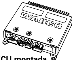
ECU montada en la cabina
